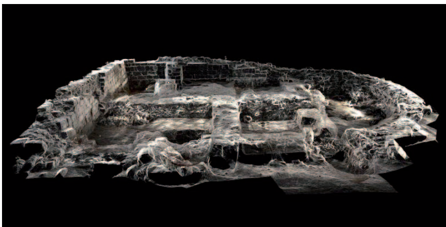
5. kép: Pomáz-Nagykovácsi-pusztá templomrom feltárás közben. A képen egy öt álláspontból készült, 225 millió pontot tartalmazó pontfelhőt látunk.
